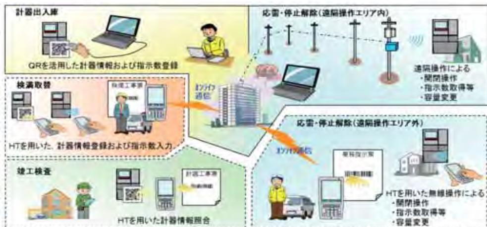
スマートメーターと関連するシステムの導入により、遠隔での設定や操作、検針ができるようになります。また、ハンディーターミナルとスマートメーターを通信させることで現地での操作等も実施できるよう業務が大きく変わります。
